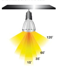
A la hora de sustituir bombillas direccionales (como las halógenas) hay que tener en cuenta el grado de apertura de la bombilla LED para asegurar la adecuada distribución de luz. Mire este dato en la información de la bombilla.
